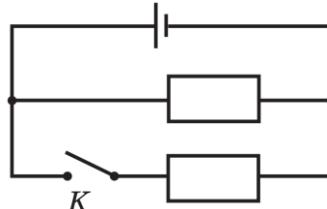
$$I_{\text{заг 1}} = \frac{U}{R_{\text{заг 1}}} = \frac{U}{R_0}$$
