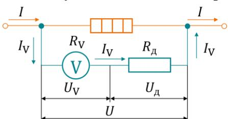
**Додатковий опір** – резистор, який послідовно приєднують до вольтметра з метою збільшити верхню межу вимірювання вольтметра.
