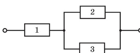
$R_2, R_3$  з'єднані паралельно:
