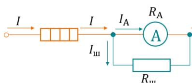
**Шунт** – резистор, який паралельно приєднують до амперметра з метою збільшити верхню межу вимірювання амперметра.
